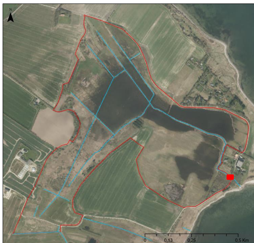
Figur 3-18. Grøfter (blå) indenfor projektområdet (rød) ved Heltborg inkl. den centrale Heltborg Pumpekanal. Pumpens nuværende placering er markeret med en rød firkant. Indeholder data fra Styrelsen for dataeffektivisering og Forsyning, hentet juli 2021.
