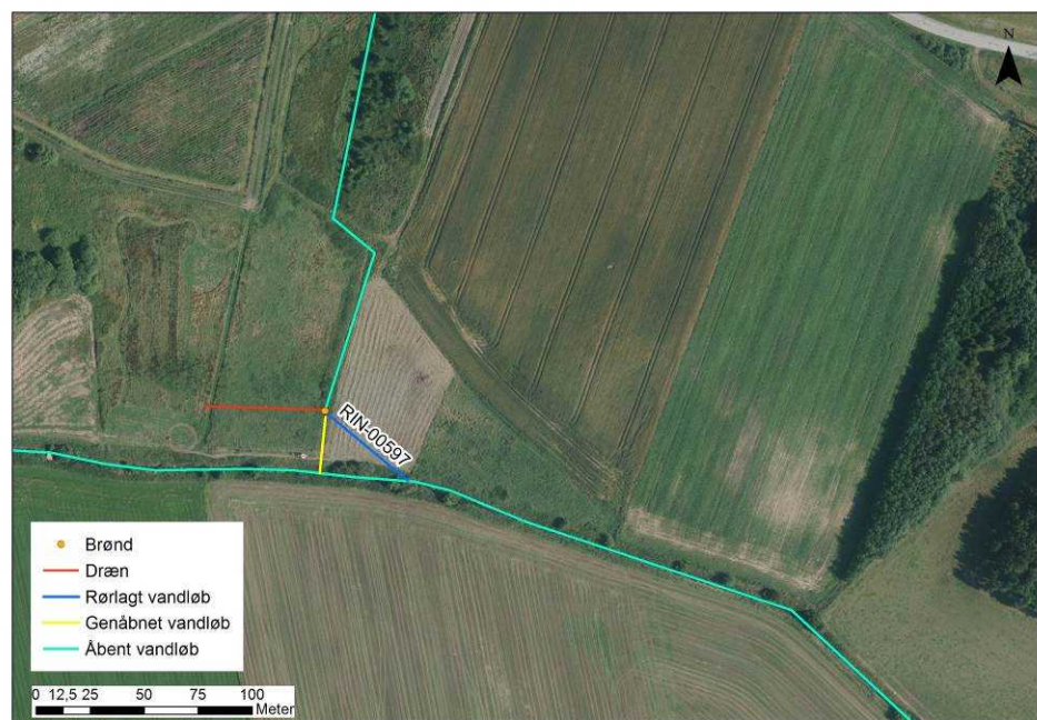
Figur 32 Placeringen af rørføringen i Vandløb Intrup.
