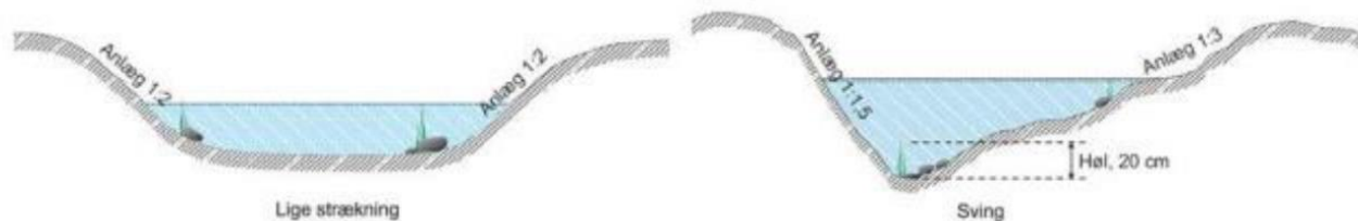
Skitse 3. Principsskitse af naturligt vandløb med forskel i bredde, anlæg og dybde mellem lige stræk og sving.
