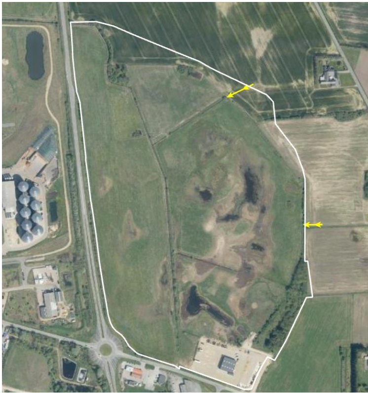
Figur 3-5: Placering af eksterne dræn fundet under opmåling (gule pile)
