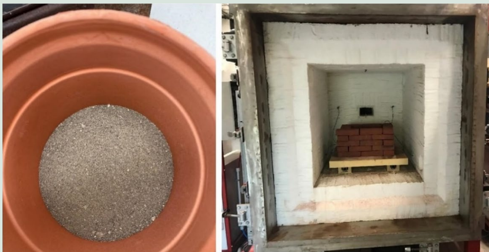
FIGUR 8. Fotoet til venstre viser den forurenede prøve af sand, som blev opbevaret i en keramisk beholder under brænding. Fotoet til højre viser ovnkammeret, hvor den keramiske beholder blev anbragt mellem opstabilede brændte mursten, som fungerede som ballast for at kunne styre temperaturen under opvarmning.
