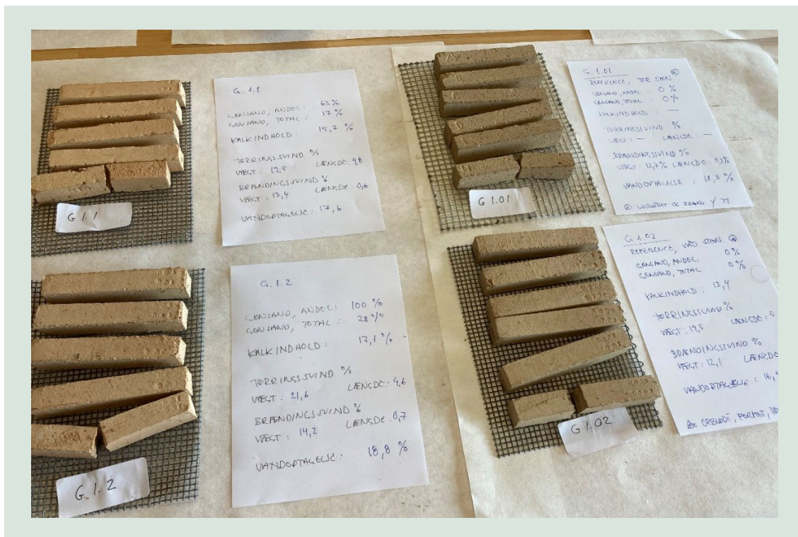
FIGUR 2. Laboratoriefremstillede teglstænger efter brænding, G-serie. Stængerne til venstre er blandet på laboratoriet. De fremstår mere gule, da der ikke er tilsat mangan. Mangan tilsættes på værket for at farve stenene og har ikke indflydelse på de målte egenskaber.
