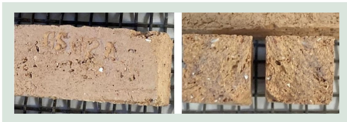
FIGUR 11. Fotos af brændte teglstænger med knust sanitet. Ikke-omdannede rester ses tydeligt som hvide korn, både på overfladen (til venstre) og ved brud inden i stængerne (til højre).
