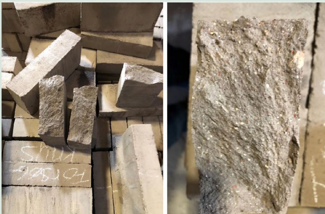
FIGUR 15. Fotos af fuldskala-fremstillede mursten på teglværket. På foto til højre ses knækket mursten. Korn af rødt og gult tegl kan ses i skærven. Dette forekommer også, når der iblandes cha-motte i blandingen.
