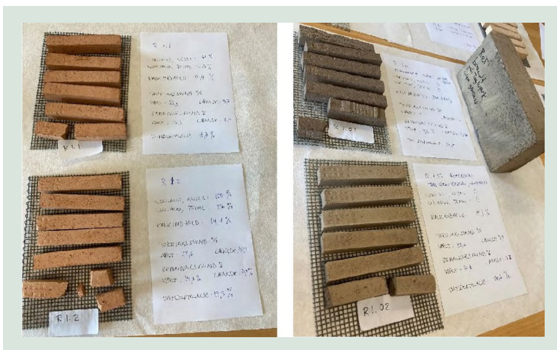
FIGUR 3. Laboratoriefremstillede teglstænger efter brænding, R-serie. Stængerne til venstre er blandet på laboratoriet. De fremstår mere rosa, da der ikke er tilsat mangan. Mangan tilsættes på værket for at farve stenene og har ikke indflydelse på de målte egenskaber.
