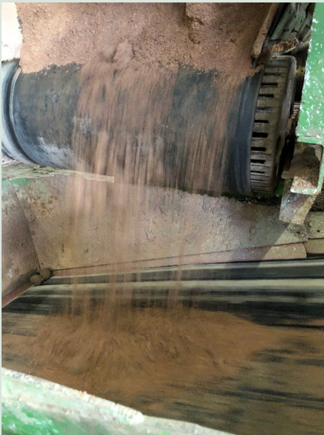
FIGUR 13. Gensand doseres til lerblanding.
