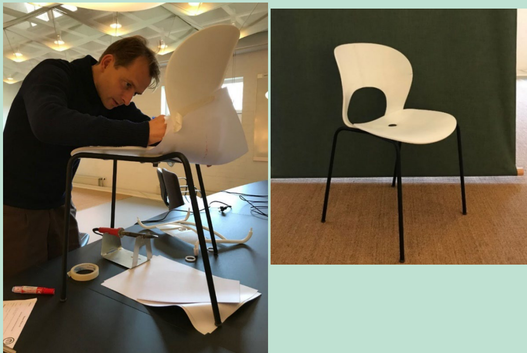
FIGUR 22. Den 3D printede prototype sammensættes, færdiggøres og står som 1:1 model.
