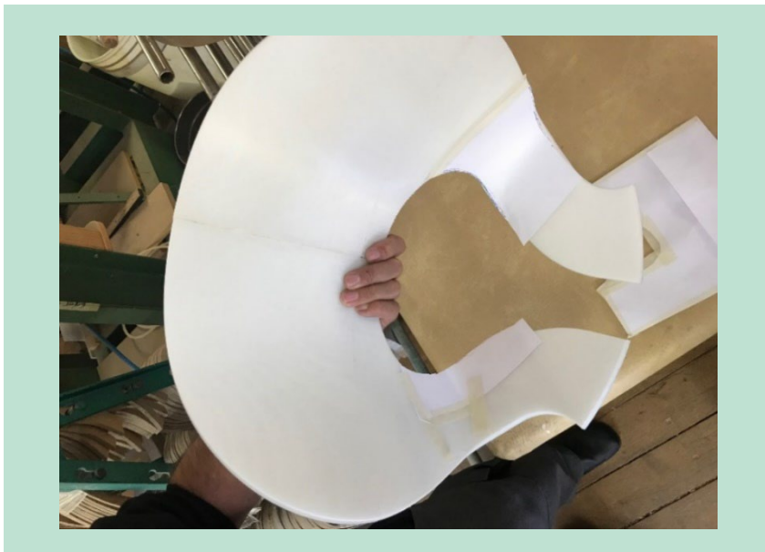
FIGUR 21. 3D printede rygskal sammensat af flere sektioner.
