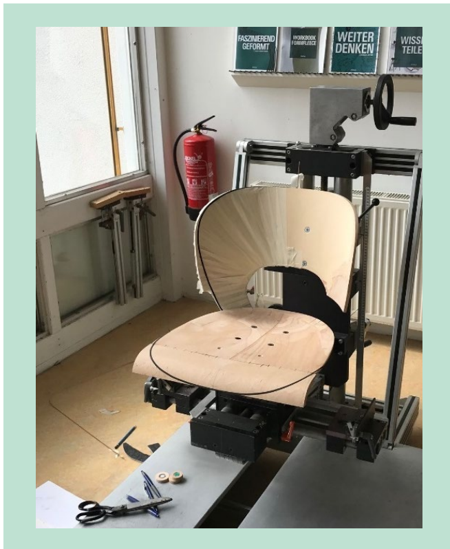
FIGUR 18. Prototype samles i vippemaskine hos fa Becker.
