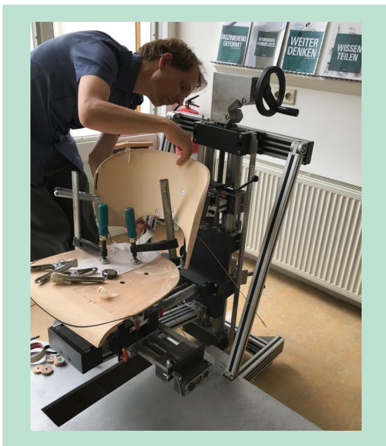
FIGUR 19. Sæde- og rygskaller bukes til de korrekte krumninger og efterfølgende skæres disse endeligt til.
