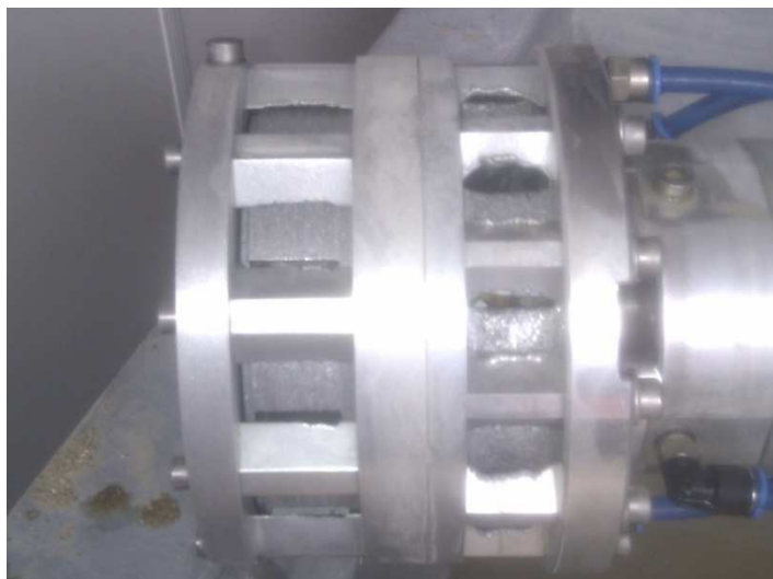
Figur 3.1.6. Sirene med 2 sirenehoveder efter 4 timers drift
