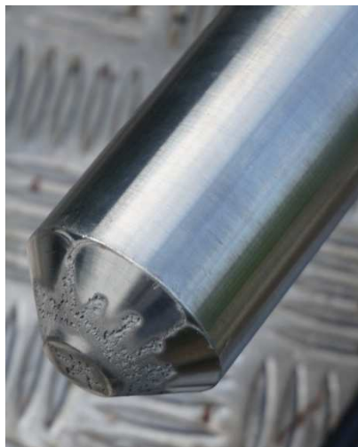
Figur 6.2.3. Kavitationsskader på sonden efter brug
