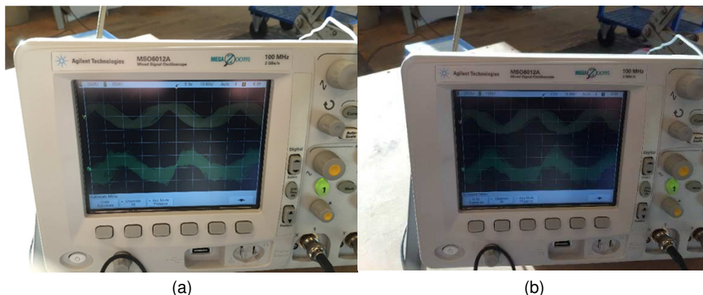
Figur 5.2.2. Intensitetsmåling for (a) flydende vand og (b) fastfrosset sonde
