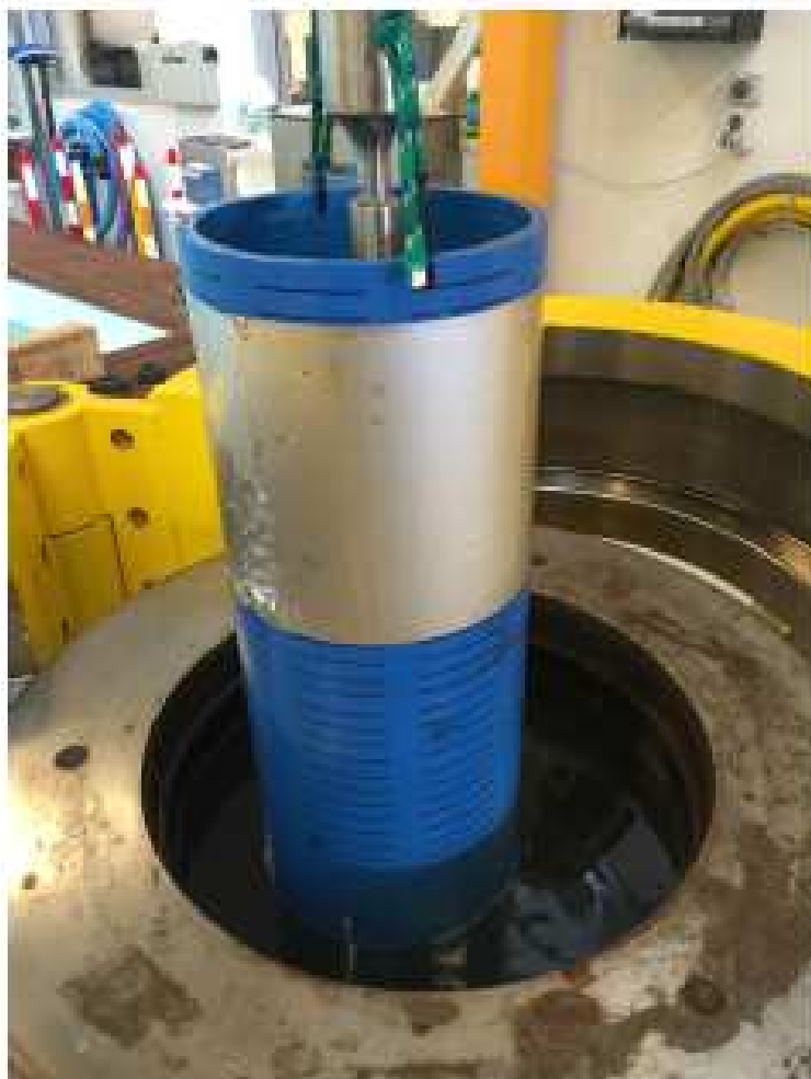
Figur 6.1.1. Filter og sonde hæves op af tryktank. Bemærk at folie viklet om filterrør nu er perforeret
