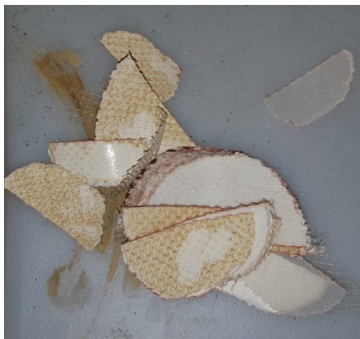
Figur 3: Membranlag fra en opsprættet brugt NF-membran. Det ses hvordan gule sandpartikler har lagt sig på membranoverfladen. De kunne let gnubbes af med en finger, som de hvide områder illustrerer.
