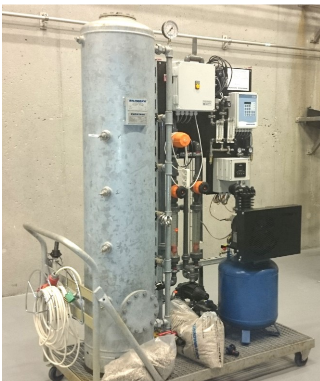
Figur 6-1 Foto af pilotanlægget anvendt til fosforfjernelsesforsøg i dette projekt.
