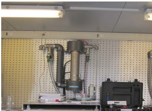
Foto nr. 9. Elektrokemisk reaktor
